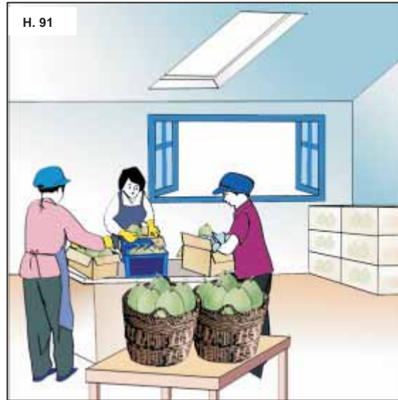
Hình 91 – Sử dụng những tấm nhựa trong trên mái nhà để tăng cường ánh sáng tự nhiên.
