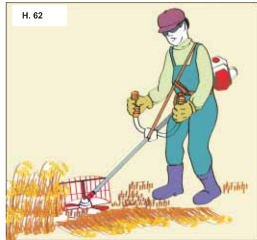
Hình 62 – Sử dụng máy cắt lúa bằng tay. Gắn tay nắm vững chắc bảo đảm an toàn cho việc vận hành.
