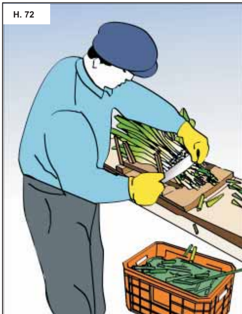
Hình 72 – Làm thiết bị cố định đơn giản để kẹp giữ những cọng hành.
