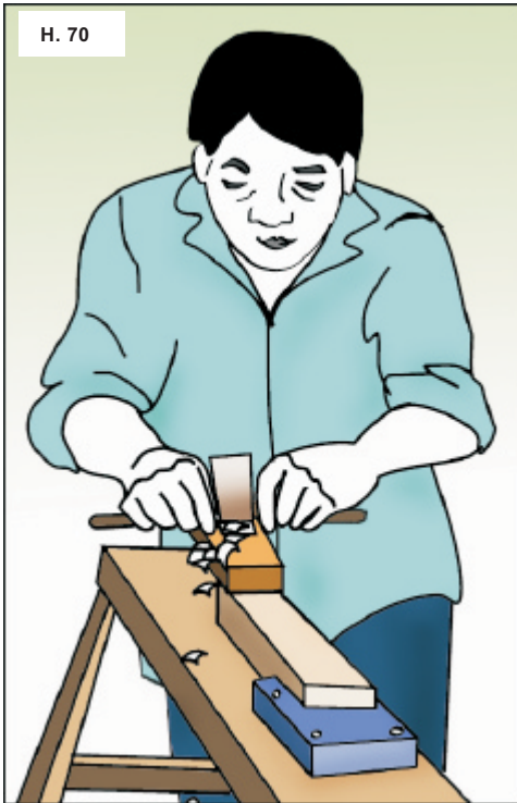
Hình 70 – Thiết bị cố định thường được dùng để kẹp chắc mảnh gỗ cần bào hoặc đẽo gọt.
