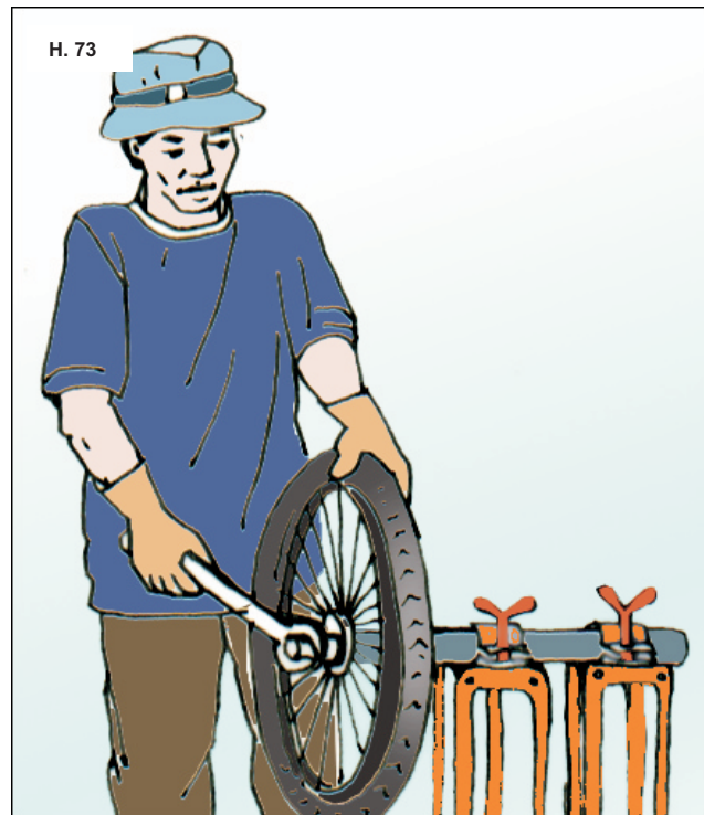
Hình 73 – Thiết bị cố định đơn giản dùng để kẹp chắc những trục bánh xe hoặc những trục lăn hình tròn khi cần phải tháo rời để bảo trì hoặc sửa chữa.
