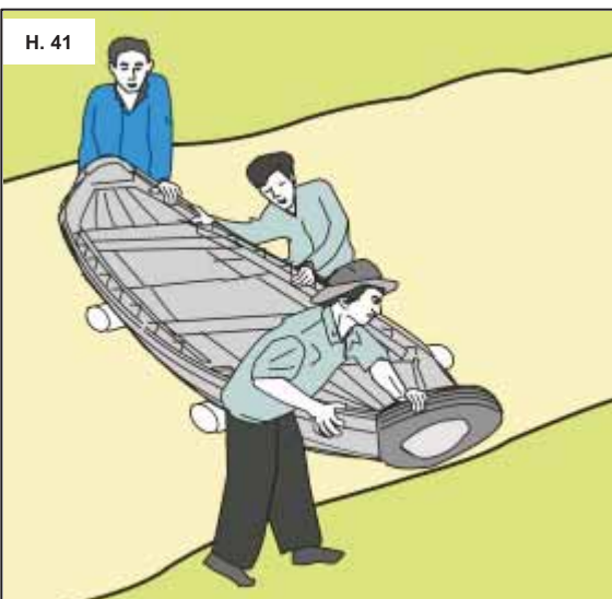
Hình 41 - Sử dụng những trục lăn khi cần phải di dời những vật nặng trên một đoạn ngắn.
