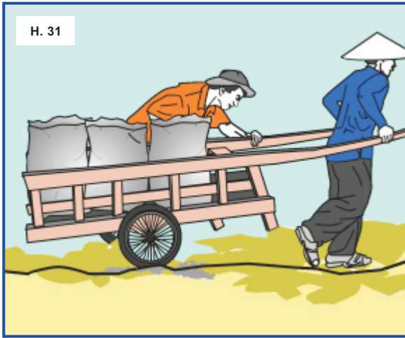
Hình 31,32- Trên mặt đường gồ ghề, xe kéo hoặc xe đẩy có bánh to dễ di chuyển hơn bánh nhỏ.
