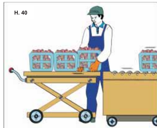
Hình 40: Dùng thiết bị nâng đơn giản để dời vật nặng ngang tầm làm việc.
