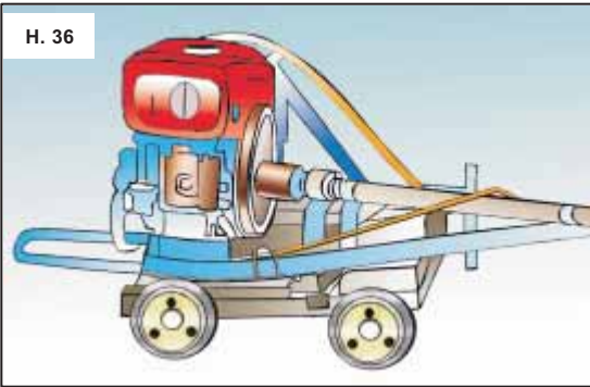
Hình 36 – Sử dụng sàn gỗ có gắn bánh xe để di chuyển các loại máy móc và nông cụ nặng.
