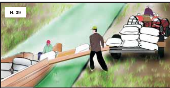
Hình 39 – Những đoạn băng chuyền ngắn rất tiện dụng và tiết kiệm sức khi cần vận chuyển những túi nông sản nặng từ nơi này sang nơi khác.
