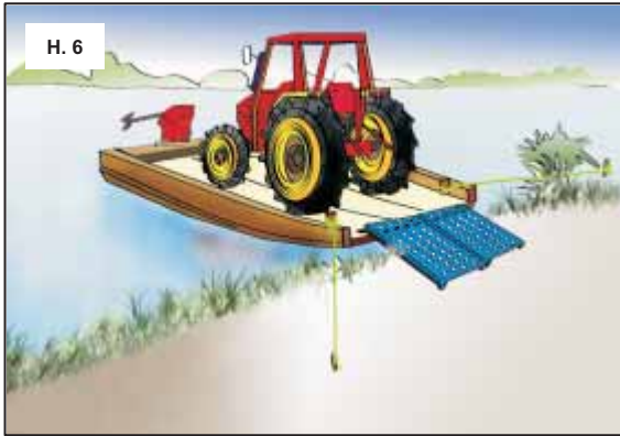
Hình 6 – Lắp đặt thêm những bục nối để làm phẳng các mô đất hoặc bờ ruộng lồi lõm.
